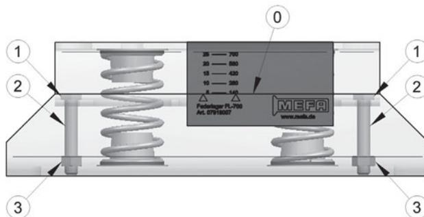
1. La molla in appoggio FL deve venire precompressa per il carico statico di esercizio che deve essere sostenuto utilizzando 2 dadi esagonali M8 [1] - chiave 13 mm. I valori possono essere rilevati dalla scala utilizzando come riferimento il bordo inferiore dell'involucro della molla [0].
