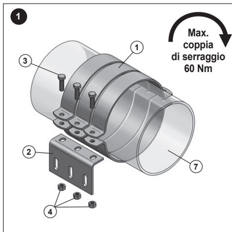
1.) Posizionare sul tubo dei collari (1) adeguatamente resistenti. Installare le squadrette (2) sotto le linguette dei collari. Serrare le viti (3) e i dadi (4) con una coppia di serraggio di 60 Nm.
