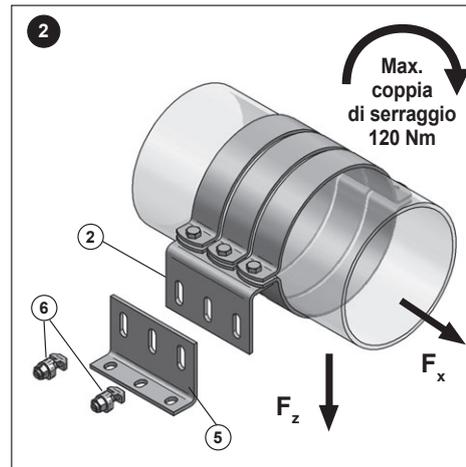
2.) Collegare le squadrette (2) alle squadrette di base (5) utilizzando le viti con testa a martello (6). Serrare le viti con una coppia di serraggio di 120 Nm. Attaccare il tutto alla struttura di supporto sottostante (binario a C, Profilo Centum).
