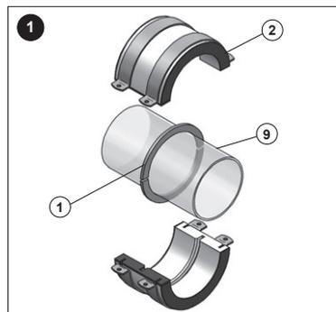
1.) Il punto fisso isolato per tubi freddi possiede al suo interno 2 semianelli in acciaio (1) da saldare sulla tubazione (9)
