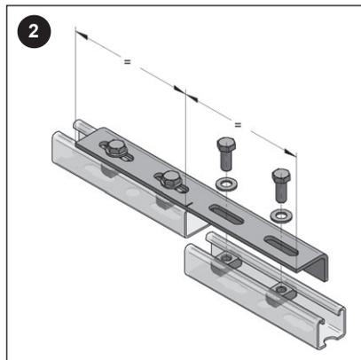
Posizionare il ponte di collegamento centrato sui due binari da collegare (vedere il marcatore centrale riportato sull'elemento). Per avere l'efficienza statica di un unico profilo intero, il ponte di collegamento deve essere sempre montato sul lato aperto dei profili da unire.
