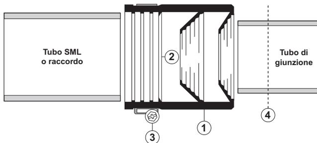
1. Mettere il giunto (1) sull'estremità del tubo o del raccordo fino allo scalino distanziatore dell'elemento di tenuta (2), quindi stringere la reggia (vite con testa a croce – SW7 – coppia di serraggio raccomandata: 2 Nm).
