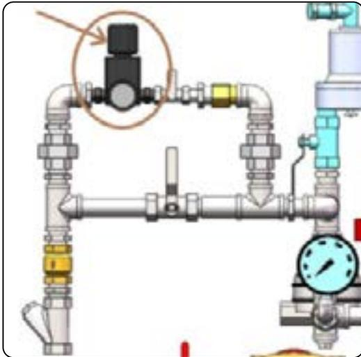
**PASSAGGIO 5:** chiudere la valvola a sfera n. 25 e quindi aprire la valvola a sfera (n. 24b) sull'acceleratore.
