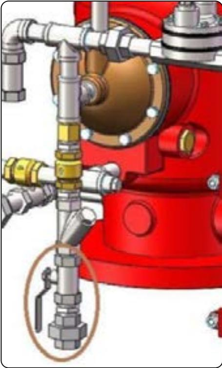
**PASSAGGIO 7:** tirare verso l'alto la valvola di scarico automatico (n. 22) fino a quando non fuoriesce più acqua dall'uscita. Controllare che il manometro (N° 20) mostri la stessa pressione dell'acqua di alimentazione.
